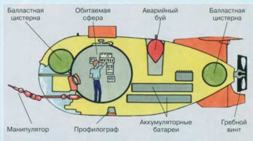
Схема внутреннего устройства подводного аппарата «Мир»
